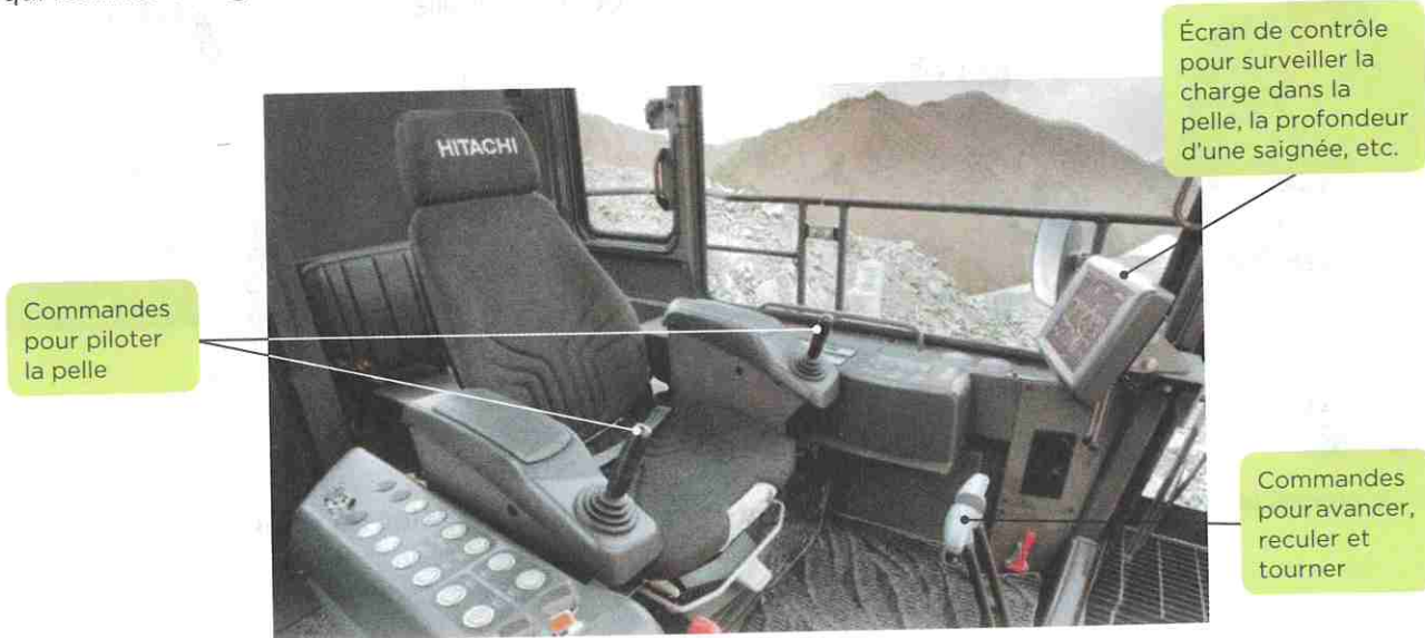
b. Les composants de la cabine de la pelleuse.
