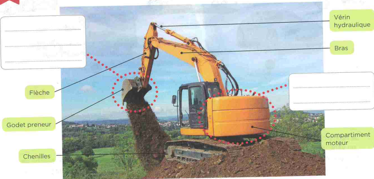
a. Les composants de la pelleuse.
